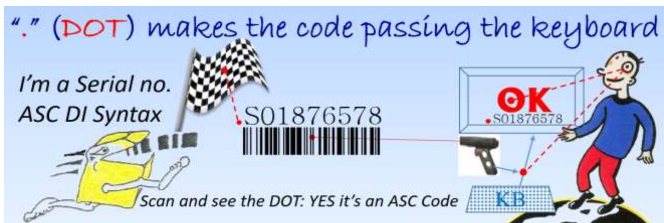
Bild 25b) Die Lösung: Der Systemidentifikator "." macht die Barcodedaten eindeutig und passierbar durch jedes Tastatur- & Webinterface. Um diese Schnittstellenprobleme zu vermeiden, definiert der Verband der Elektronikindustrie EDIFICE die "Guideline für web- und tastaturkompatible Codierung" den "Punkt (.)" als Systemidentifikator (siehe auch DIN 66403)
