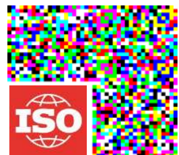
Bild. 12) JAB Code geformt als Winkel Quelle: Waldemar Berchtold, Fraunhofer Institut, Darmstadt, DE
