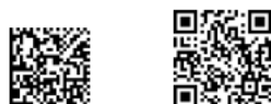
Bild 30) Beispiel „upUI“ → 5RQC... codiert in Data Matrix und/oder QR Code (gedruckt in gleicher Punktgröße)
